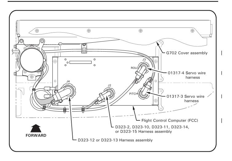
FIGURE 22-2 FLIGHT CONTROL COMPUTER
